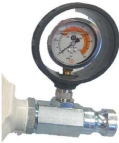
Figura 22: Manômetro de pressão da argamassa
