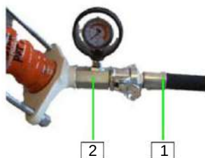
Figura 37: Conectando a mangueira de argamassa
