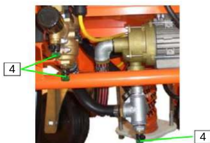
Figura 60: Abrindo as torneiras de saída
