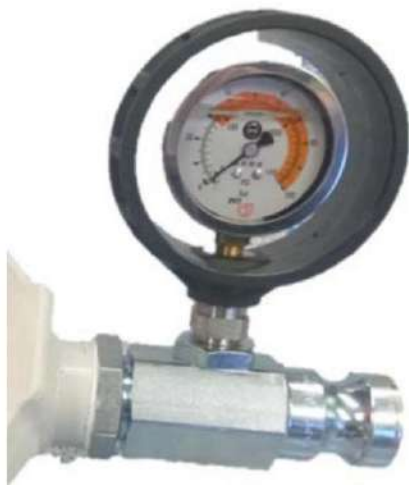
Figura 17: Manômetro de pressão da argamassa
